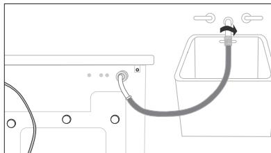
2. Подсоедините другой конец шланга для подачи воды к крану водопроводной системы и затяните соединение рукой. В случае необходимости, вы можете изменить положение конца шланга для подачи воды, подключенного к стиральной машине, для чего ослабьте фитинг, поверните шланг и вновь затяните фитинг.
